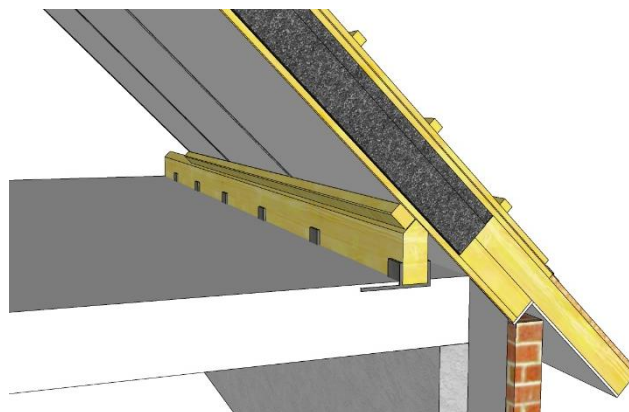
Figuur 1 - Muurplaat en afschuifregel (dakvoet)
